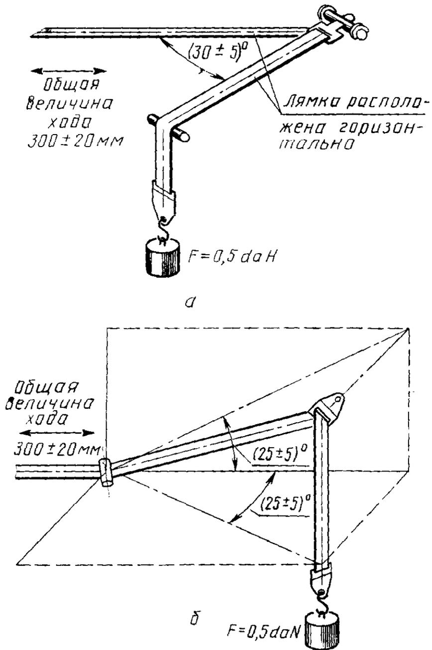
а—испытание с пряжкой; б—испытание с направляющим устройством
