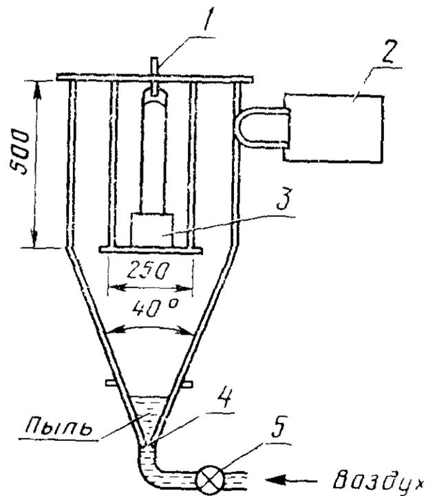
1—механизм для приведения в возвратно-поступательное движение цилиндра; 2—пылеуловитель; 3—стягивающее устройство; 4—отверстие; 5—хранилище и фильтр
