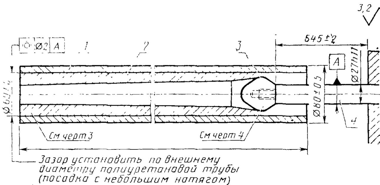
1—стальная труба на тележке; 2—полнуретановая труба; 3—овальный наковечник; 4—шток
