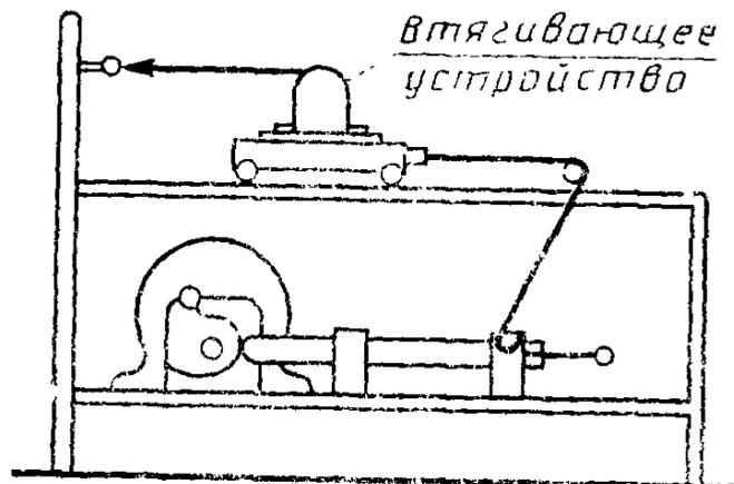
Установка состоит из кулачка с приводом для двигателя. Толкатель кулачка связан тросом с небольшой тележкой, установленной на направляющих. Кулачок и число оборотов двигателя рассчитаны таким образом, чтобы давать требуемое ускорение при приросте ускорения, указанном в п. 7.6.2.2 настоящих Правил. Ход кулачка рассчитан с превышением максимально допустимого перемещения ремня, при котором срабатывает втягивающее устройство.
