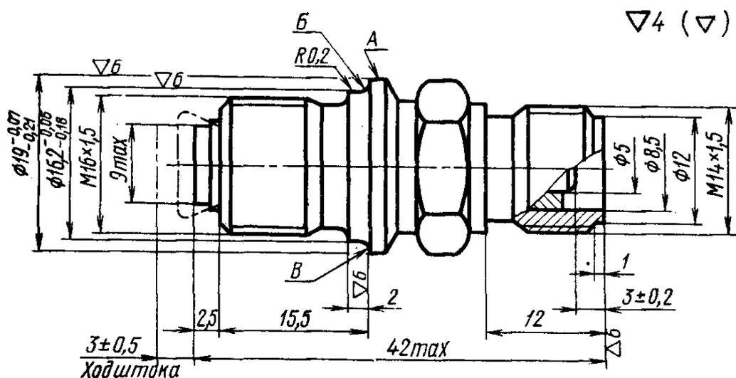
2.2. Несоосность поверхностей А и В относительно среднего диаметра резьбы М16×1,5 — не более 0,07 мм.
