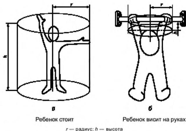
Рисунок 11 — Размеры цилиндра для определения зоны безопасности
