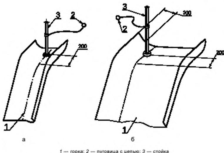
Рисунок Г.10 — Размещение испытательного устройства на горке
