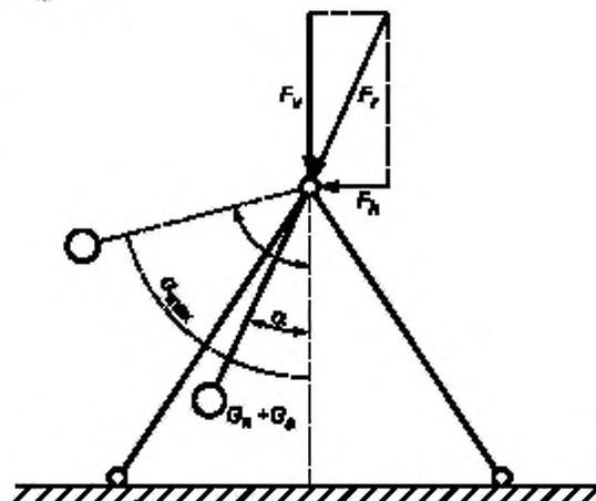
$F_h$  — горизонтальная нагрузка на узел;  $F_v$  — вертикальная нагрузка на узел;  $F_r$  — нагрузка на узел;  $G_s$  — масса качелей;  $G_n$  — масса детей;  $\alpha$  — угол отклонения качелей;  $\alpha_{\text{max}}$  — максимальный угол отклонения качелей  $80^\circ$ .
