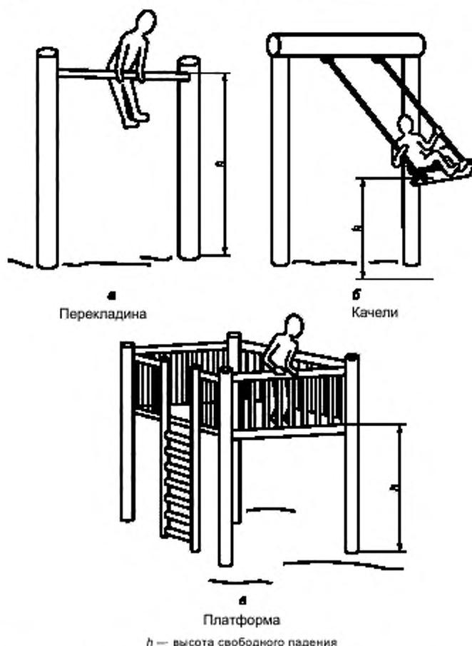
Рисунок 13 — Высота свободного падения  $h$  для различного оборудования
