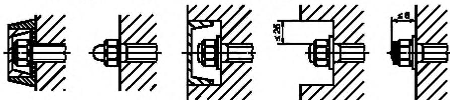
Рисунок 4 — Защита болтовых соединений
