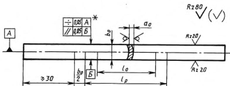
\* Размеры обеспечиваются при изготовлении: установкой заготовки и настройкой режущего инструмента.
