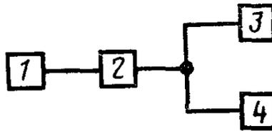
1—генератор шумового сигнала, 2—приемник; 3—эквивалент нагрузки; 4—вольтметр переменного тока
