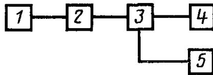
1—генератор сигналов; 2—согласующее устройство (эквивалент антенны) и антенноатор на 20 дБ; 3—приемник; 4—эквивалент нагрузки; 5—осциллограф
