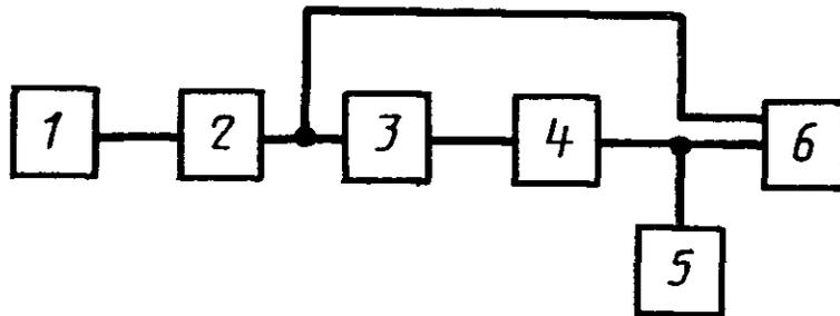
1—генератор ЗЧ; 2—датчик испытательных сигналов; 3—генератор сигнала ВЧ; 4—приемник; 5—эквивалент нагрузки; 6—осциллограф
