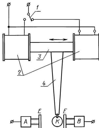
1 — выключатель, управляемый двигателем или любым другим аналогичным устройством; 2 — катушка; 3 — втягиваемый сердечник; 4 — стержень из изоляционного материала
