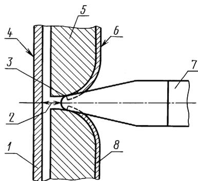
1 — часть под опасным напряжением; 2 — зазор; 3 — точка, от которой измеряется путь утечки; 4 — внутренняя поверхность; 5 — задняя стенка; 6 — внешняя поверхность; 7 — испытательный палец; 8 — мнимый теплопроводящий слой
