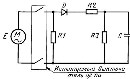
$R_1 = \frac{E}{I}$ ; где  $E$  — номинальное напряжение,  $I$  — номинальный ток;  $R_2 = \frac{R_1 \sqrt{2}}{X}$ , где  $X$  — отношение между пиковым превышением тока и номинальным эффективным значением тока;  $R_3 = \frac{800}{X} \cdot R_1$ ;  $CR_2 = 2500$  мкс;  $D$  — кремниевый выпрямитель
