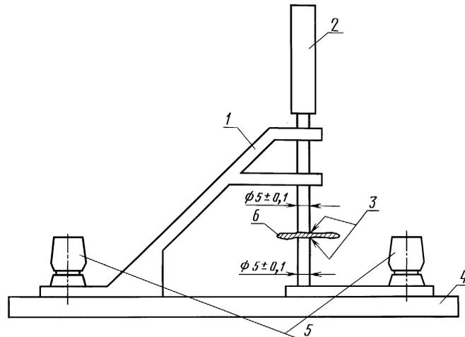
1 — металлическая рама, удерживающая штырь в вертикальном положении и обеспечивающая возможность его подъема и спуска; 2 — металлический штырь массой 100 г; 3 — края штыря закруглены радиусом 0,5 мм; 4 — изолирующая подставка; 5 — клеммы для подведения испытательного напряжения; 6 — испытуемый образец
