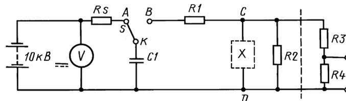
$$C_1 = 1 \text{ нФ}; R_1 = 1 \text{ кОм}; R_2 = 4 \text{ кОм}; R_3 = 100 \text{ МОм}; R_4 = 0,1 \text{ МОм}; \\ R_5 = 15 \text{ МОм}$$
