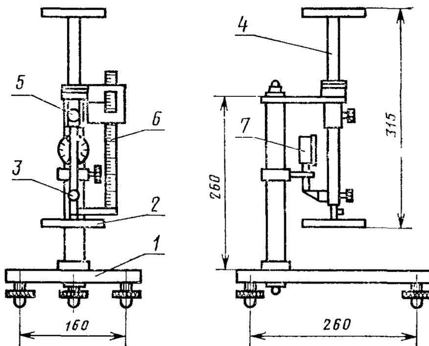
1—плита со станиной; 2—пластина квадратной формы размером 100×100 мм; 3—зажимный винт пластины 2; 4—движущая часть прибора; 5—зажимный винт движущей части; 6—измерительная линейка; 7—индикатор часового типа.
