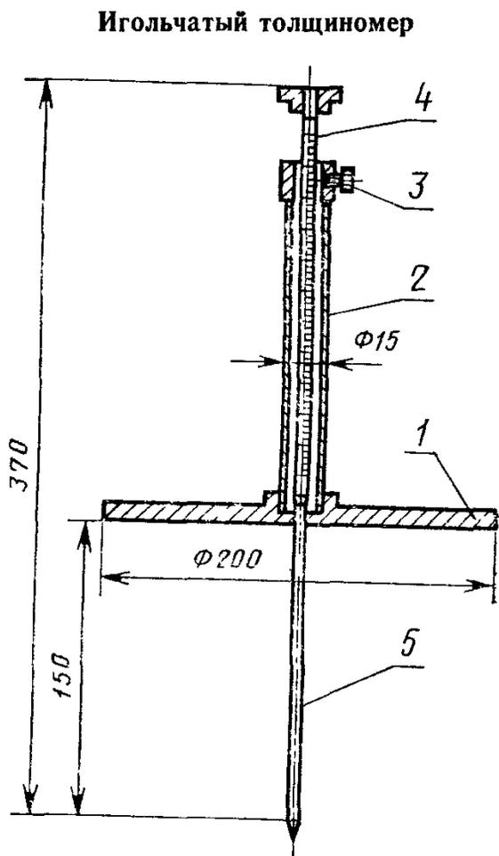
1—диск; 2—трубка; 3—винт; 4—стержень;
