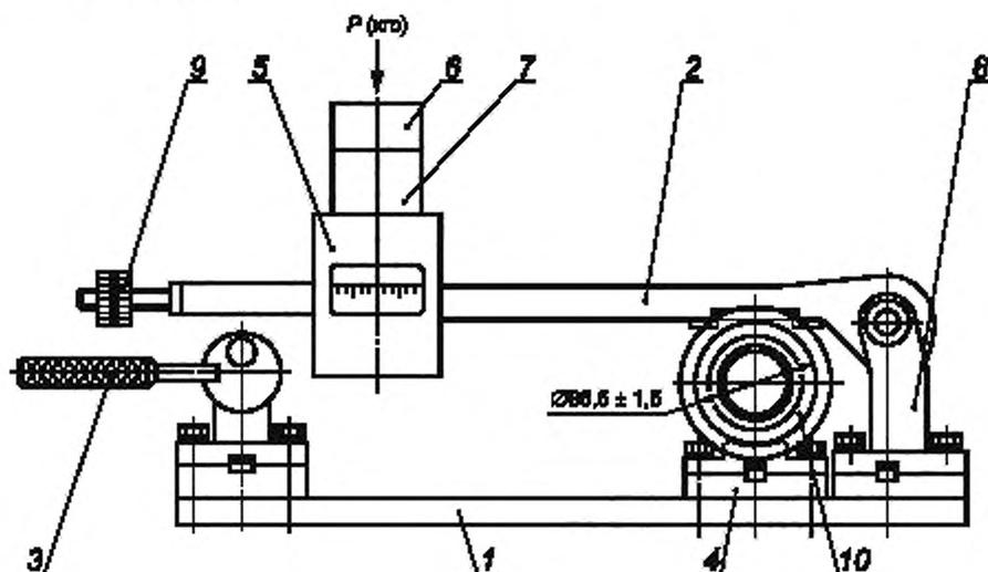
1 — основание прибора; 2 — рычаг; 3 — эксцентрик с ручкой; 4 — опора; 5 — контргруз; 6, 7 — дополнительные контргрузы; 8 — кронштейн; 9 — гайки-контргрузов; 10 — мишень
