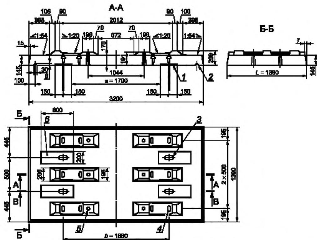
1 — плоскость опирания плиты на балку; 2 — слезник; 3 — отверстие для крепления плиты к балке (максимальное расстояние между шпильками  $b = 1860$  мм),  $L = 1390$  мм — длина плиты; 4 — отверстие для крепления рельса; 5 — отверстие для крепления контруголка; 6 — площадка для опорной шайбы под гайкой высокопрочной шпильки
