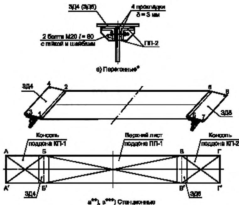
\* Конструкция закладного элемента объединения плиты (зд4, зд8) с верхним поясом главной балки (ПП-2 — фиксаторы закладных деталей).
