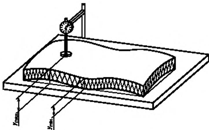
Рисунок 2 — Измерение максимального и минимального расстояний
