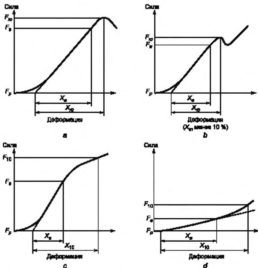
$F_p$  — сила, соответствующая предварительной нагрузке;  $F_m$  — максимальная сила;  $X_m$  — деформация при максимальной силе;  $F_{10}$  — сила при относительной деформации, равной 10 %;  $X_{10}$  — относительная деформация, равная 10 %;  $F_e$  — сила, соответствующая деформации  $X_e$  (условный прямо пропорциональный предел);  $X_e$  — деформация в условно упругой зоне (верхняя граница условно упругих деформаций)
