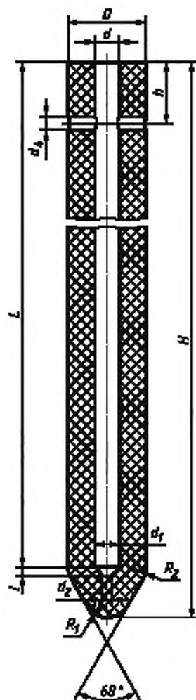
Рисунок 3 — Стопор-моноблок номеров 2,5
