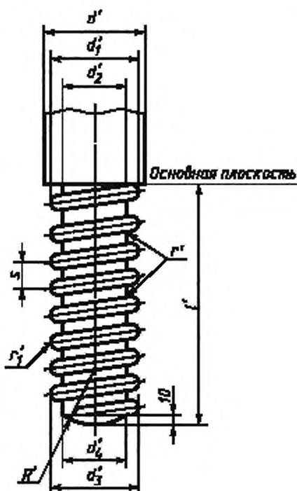
Рисунок А.1 — Винтовая нарезка металлического стопорного штыря
