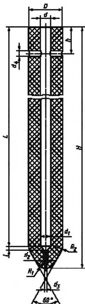
Рисунок 2 — Стопор-моноблок номеров 3,4
