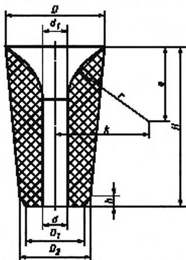
Рисунок 4 — Стакан-дозатор номеров 9—12,15,16,18
