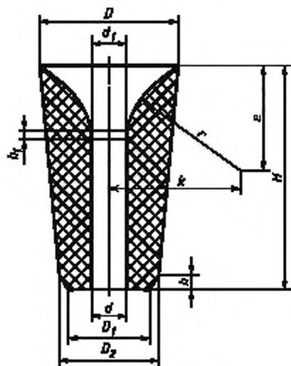
Рисунок 5 — Стакан-дозатор номеров 13,14,19—21
