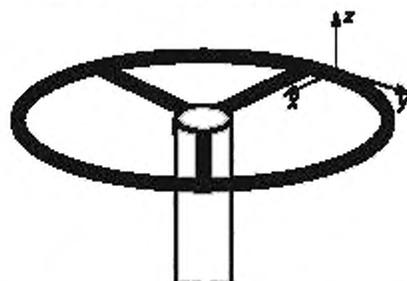
Рисунок 2 — Направления измерений на рулевом колесе
