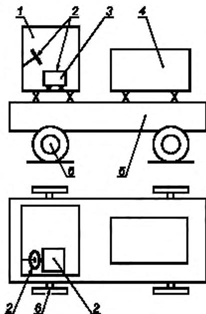
1 — кабина; 2 — точка измерения параметра вибрационной характеристики (сиденье, рулевое колесо);
