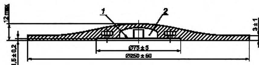
1 — тонкая металлическая пластина для установки акселерометра;
