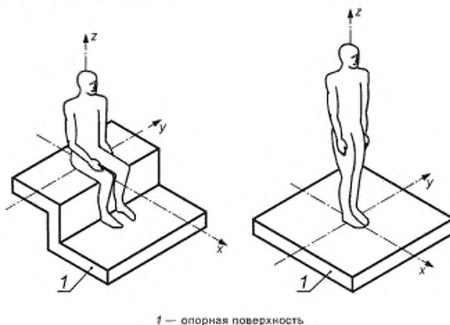
Рисунок 1 — Направления осей базицентральной системы координат
