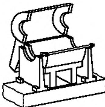
Рисунок С.2 — Кожух ротора для горизонтального балансировочного станка
