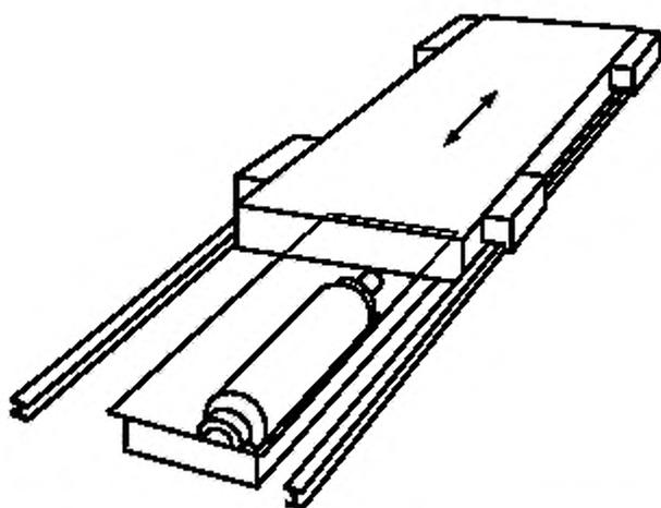
Рисунок С.5 — Прямок с крышкой для высокоскоростного балансировочного станка
