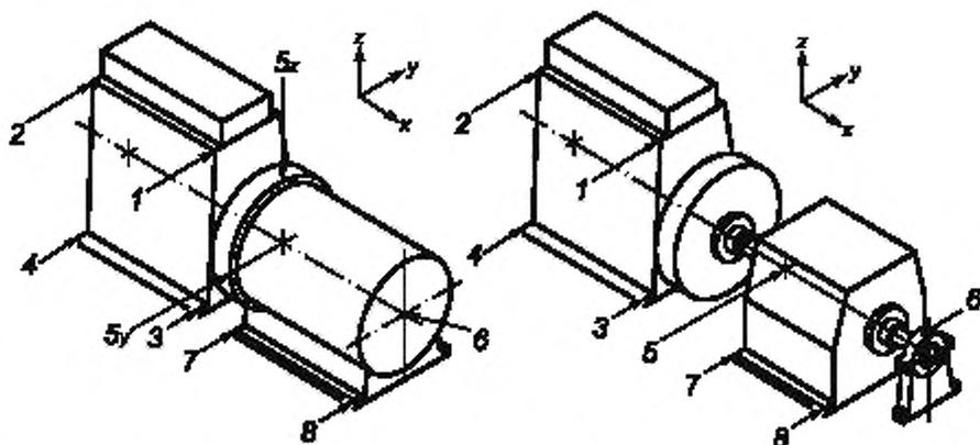
а) Электроагрегат с приводом от вертикально-однорядного двигателя, соединенного с генератором через фланцевый щит
