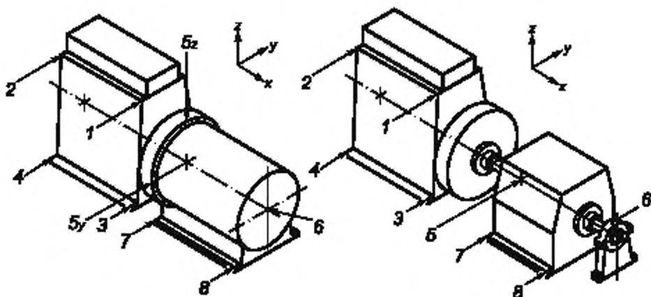
На подробном чертеже указывают точки измерений и их число подобно тому, как это показано на рисунке 1. Дополнительные точки измерений должны быть последовательно пронумерованы и отображены на чертеже.
