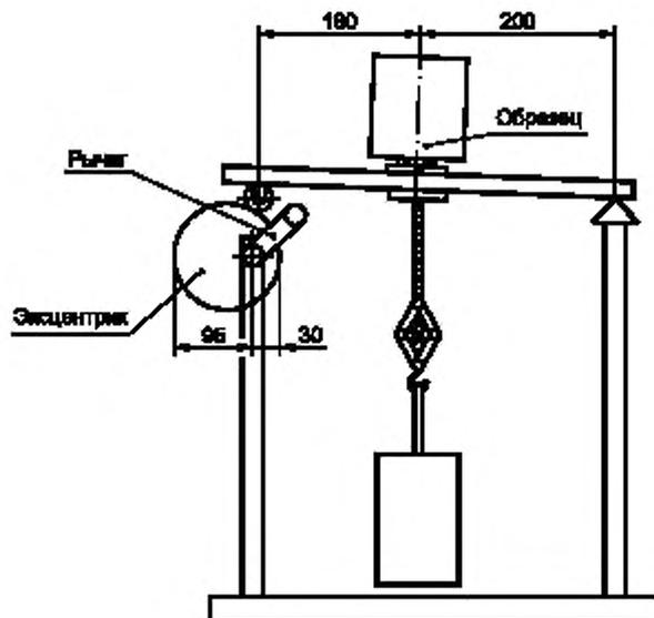
Рисунок 102 — Испытательное устройство для испытания анкерного крепления проводов
