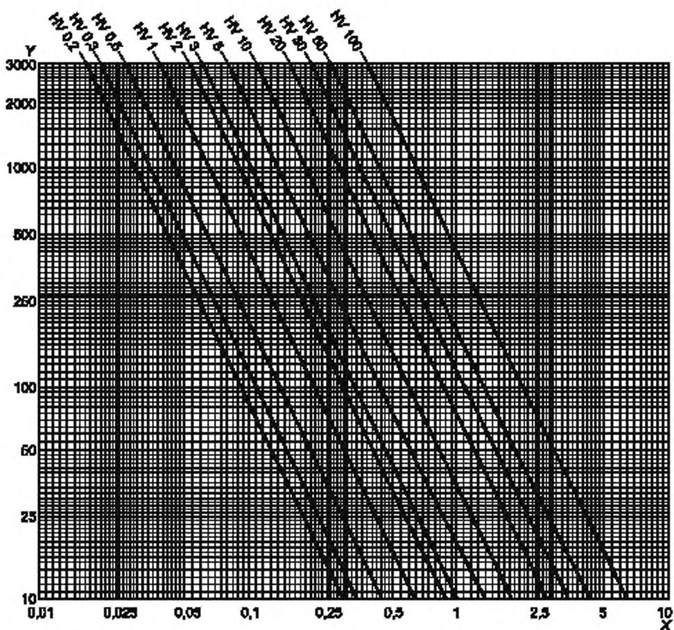
Ось X — толщина испытуемого образца, мм, ось Y — твердость HV
