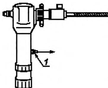
1 — датчик вибрации (на корпус прямой машины для измерений вибрации в направлении возвратно-поступательного движения вставного инструмента датчик устанавливают через переходный блок)
