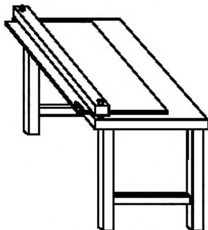
Рисунок 4 — Испытательный стенд для пил
