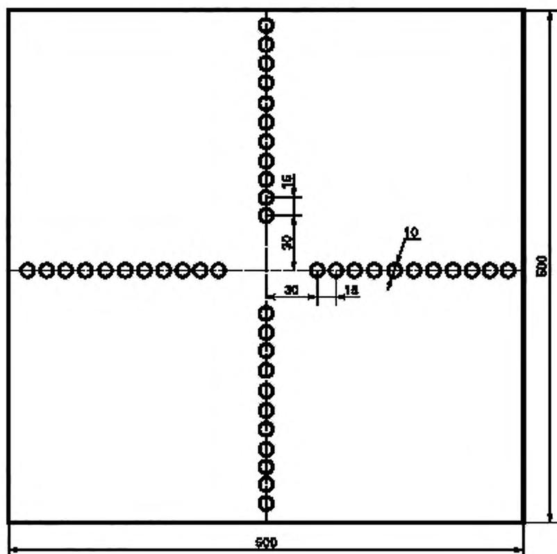
$d$  — диаметр отверстия (10 мм). Толщина тест-объекта 1 мм. Одна сторона полированная, другая подлечит чернению.
