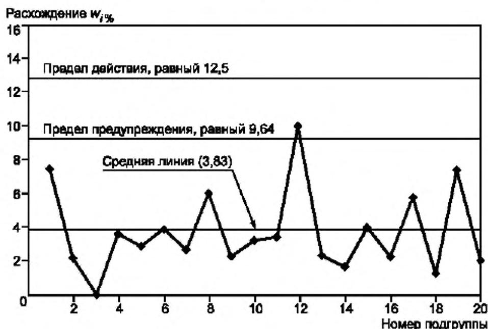
Рисунок В.2 — Карта пределов определения массовой концентрации 2-пропанола ( $\text{мг}/\text{дм}^3$ ) в спирте, полученных в условиях промежуточной прецизионности с изменяющимися факторами «время» и «оператор»
