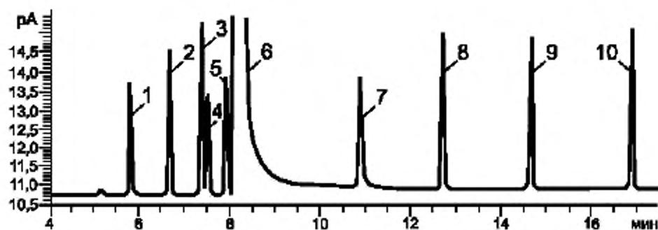
1 — уксусный альдегид; 2 — метилацетат; 3 — этилацетат; 4 — метанол; 5 — 2-пропанол; 6 — этиловый спирт; 7 — 1-пропанол; 8 — изобутиловый спирт; 9 — 1-бутанол; 10 — изоамиловый спирт
