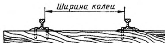
3. Ширина колеи узкоколейных железных дорог устанавливается:
