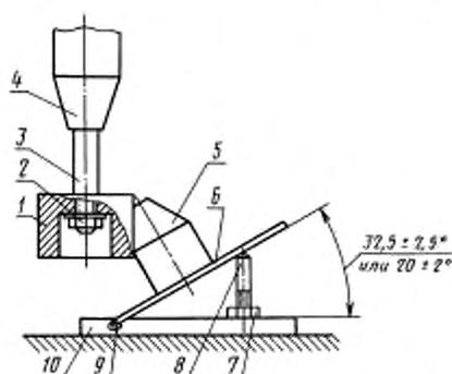
1 — шлифовальный камень; 2 — гайка; 3 — шток; 4 — патрон сверлильного станка; 5 — штанцевый нож; 6 — подвижная плита; 7 — регулировочная гайка; 8 — регулировочная шпилька; 9 — ось; 10 — неподвижная плита
