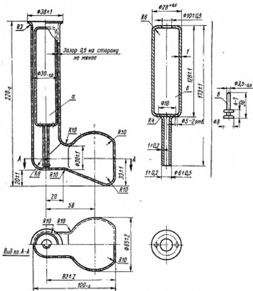
а — реакционная колба; б — держатель с трубчатой ножкой. в — стержень.
