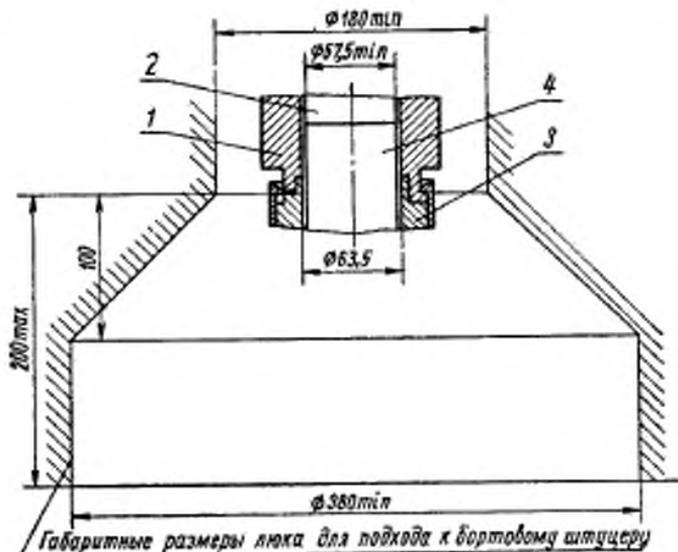
1—штуцер бортовой; 2—клапан штуцера; 3—наконечник наземного устройства; 4—клапан наконечника.
