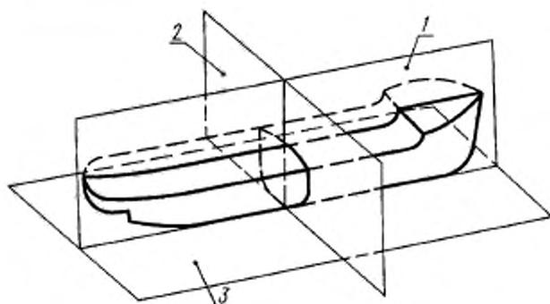
1 — диаметральной плоскости; 2 — плоскости мидель-шпангоута; 3 — основной плоскости
