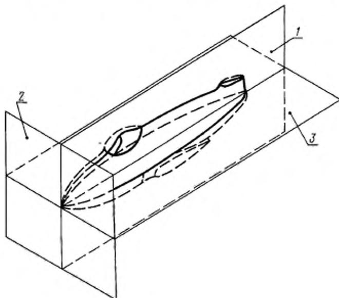
1 — плоскости симметрии; 2 — плоскости дистанции 0; 3 — плоскости строительной горизонтали
