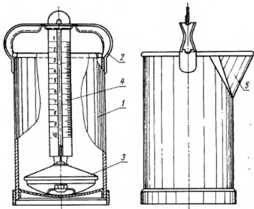
1 — корпус; 2 — ручка; 3 — поплавок; 4 — шкальная пластина; 5 — носик
