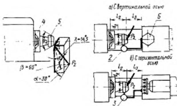
1—индикатор для измерения относительных перемещений оправки на шпинделе и поперечного суппорта; 2—индикатор для измерения относительных перемещений оправки на шпинделе и револьверной головки с вертикальной осью; 3—индикатор для измерения относительных перемещений оправки на шпинделе и револьверной головки с горизонтальной осью.
