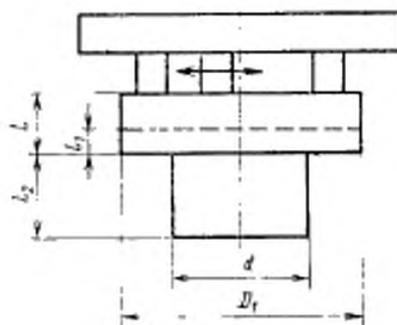
$D_1 \leq \frac{1}{2} D_{\text{max}}$ , но не более 300 мм, где  $D_{\text{max}}$  наибольший диаметр обрабатываемого изделия над станком,  $d = 0,75 D$ .
