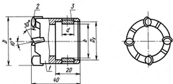
1 — корпус; 2 — пластинка твердосплавная по технической документации, утвержденной в установленном порядке; 3 — шип
