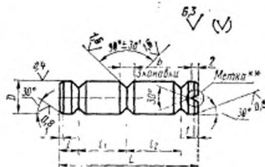
\*\* Метка наносится со стороны, входящей в корпус.
