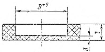
Трубчатый или цилиндрический образец
