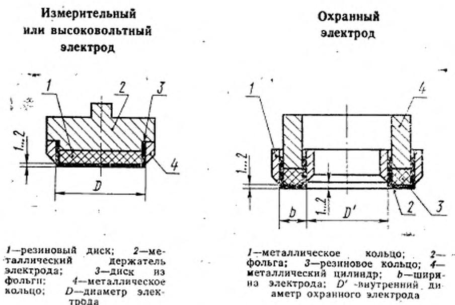
$$D' = D + 2g, \text{ где } g \text{ — зазор между измерительным и охранным электродами}$$
