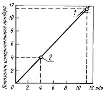
1 — показание измерительного прибора с щелочным безводным буфером равно 11,5;
