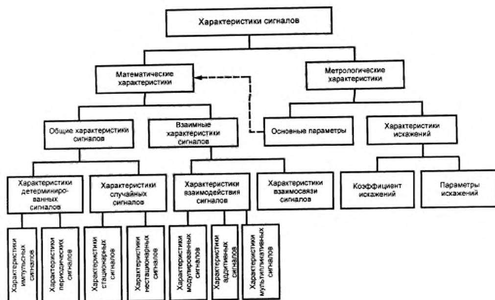
Классификация измерительных радиотехнических сигналов
