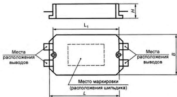
Рисунок А.1 — СЭМ 0, вариант исполнения 1
