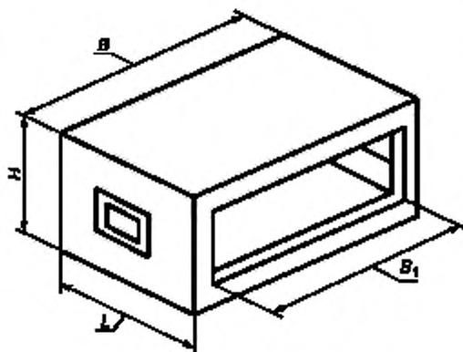
Рисунок 4 — Размеры корпусов СЭМ 3 на базе моноблока
