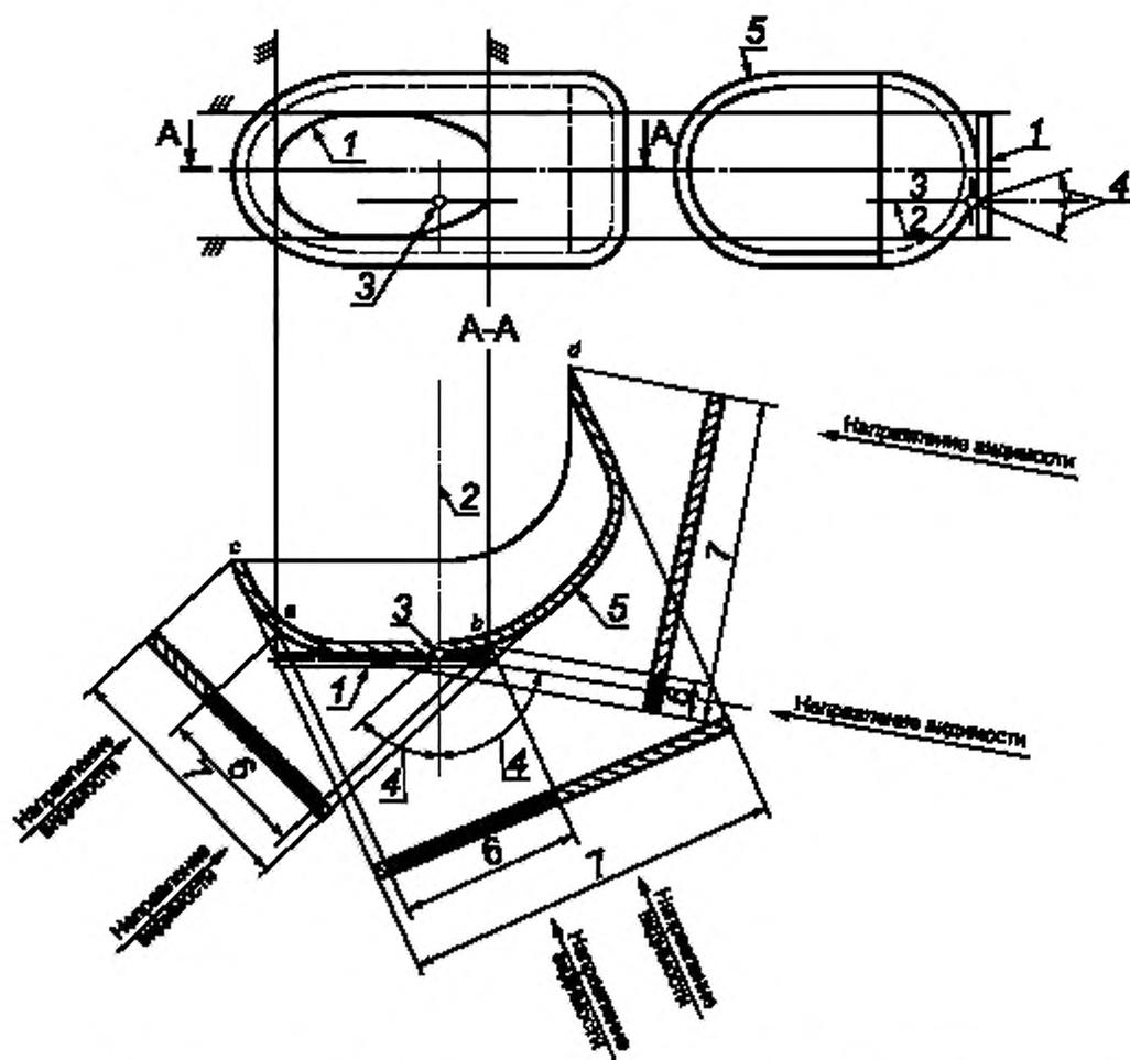
1 — освещающая поверхность; 2 — исходная ось; 3 — исходный центр; 4 — угол геометрической видимости;
