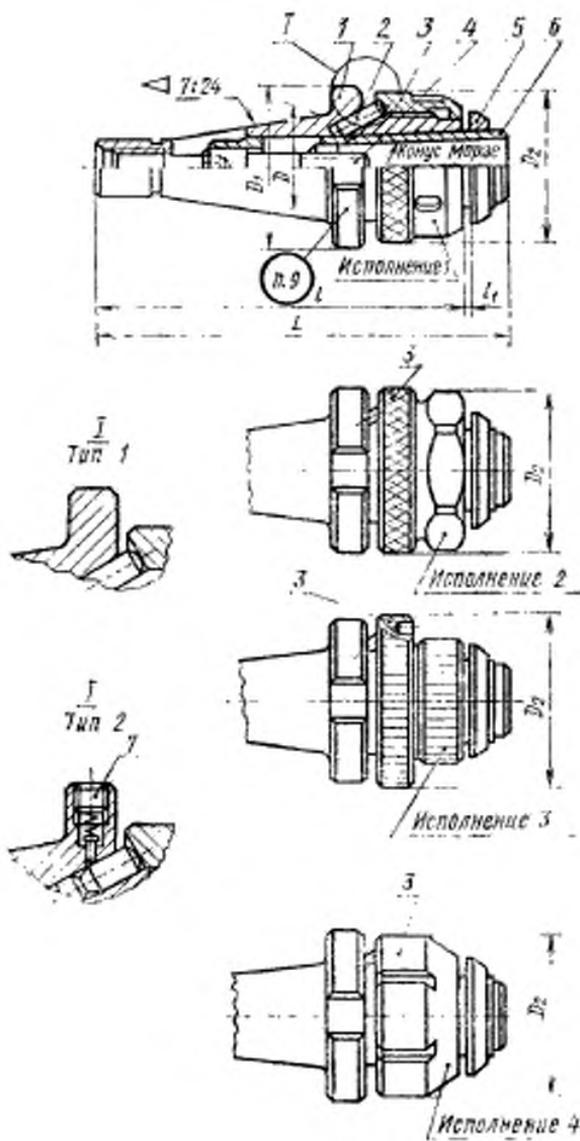
1—корпус; 2—толкатель; 3—гайка; 4—винт; 5—кольцо; 6—переходная втулка;
