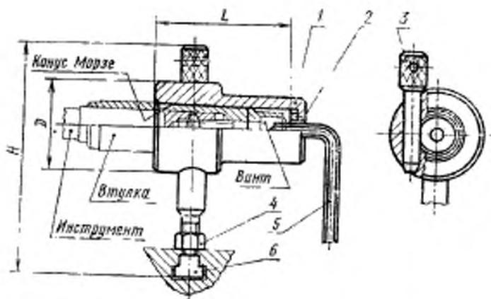
1—корпус; 2—втулка опорная; 3—фиксатор; 4—гайка по ГОСТ 5915—70;
