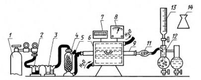
Установка для определения содержания серы состоит из следующих элементов; баллона с кислородом *I*, снабженного редукционным вентилем для пуска и регулирования тока кислорода; склянки Тищенко 2, содержащей раствор марганцовокислого калия в растворе 300 г/дм<sup>3</sup> гидроокиси
