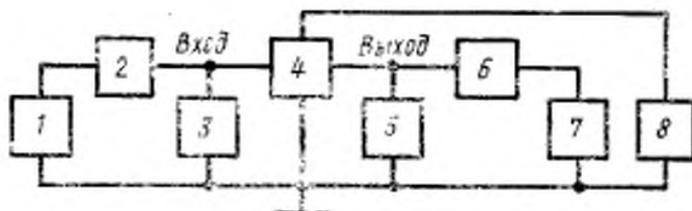
1—генератор постоянного напряжения (тока); 2, 6—измерители вольт-амперного тока; 3, 5—измерители постоянного напряжения; 4—переключатель; 7—генератор постоянного тока; 8—блок питания.
