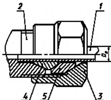
1 — труба; 2 — конец корпусной детали; 3 — накидная гайка по ГОСТ 23353; 4 — кольцо зажимное по ГОСТ 28918;
