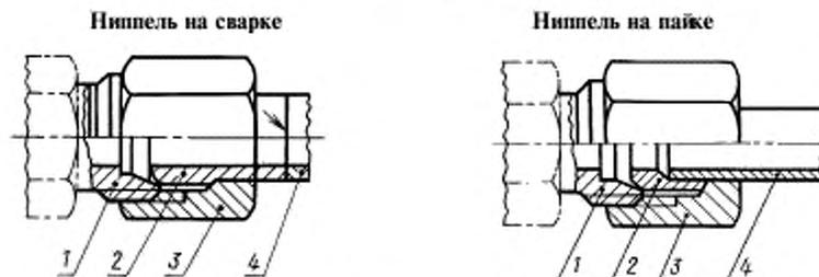
1 — конец корпусной детали; 2 — ниппель по ГОСТ 23355; 3 — накидная гайка по ГОСТ 23353; 4 — труба
