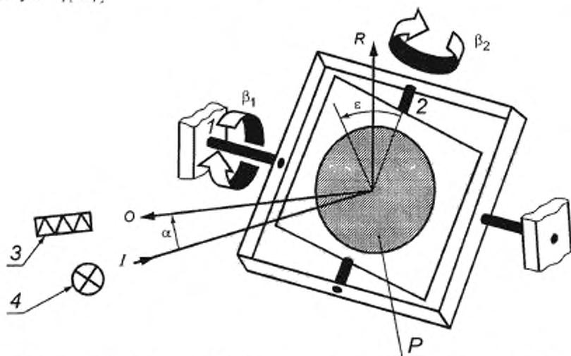
*I* – первая ось; *2* – вторая ось; *3* – фотометрическая головка; *4* – источник света,
