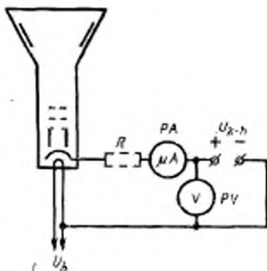
$U_{k-h}$  — источник напряжения катод-подогреватель;  $U_h$  — источник напряжения накала;
