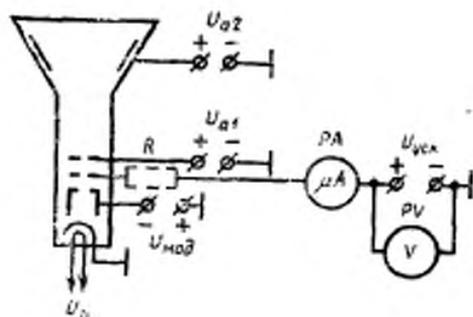
$U_{a2}$  — источник напряжения второго анода;
