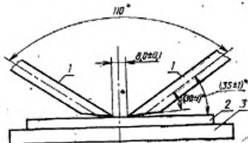
*1*—вольфрамовый электрод; *2*—испытываемый образец; *3*—подставка для образца
