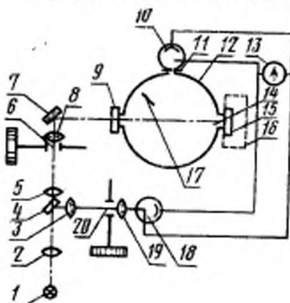
1—источник света; 2—конденсор; 3, 5, 8, 15—линзы; 4—светоделительная пластина; 6—измерительная диафрагма; 7—поворотное зеркало; 9—образец; 10, 19—фотоэлементы; 11—молочное стекло; 12—фотометрический шар; 13—нуль-гальванометр; 14—выходное отверстие; 15—белая пластина; 16—световая ловушка; 17—шар; 18—компенсационная диафрагма
