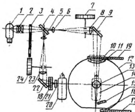
Свет лампы 1, пройдя конденсор 2, светофильтр 3 и светоделительную пластину 4, поступает далее через линзы 6 и 8 и поворотное зеркало 9 в фотометрический шар 12.
