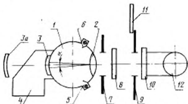
1—фотометрический шар; 2—коллиматорный объектив; 3—кольцевой сегмент; 3а—сплошной сегмент; 4—имитатор черного предмета; 5—источник света; 6—заслонки; 7—диафрагма шара; 8—испытываемое изделие; 9—диафрагма фотоприемника; 10—фотоприемник; 11—матовое стекло; 12—измерительный прибор
