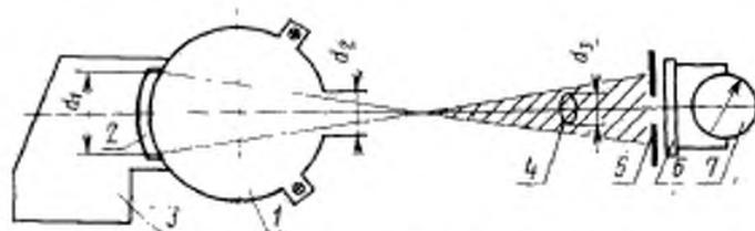
1—фотометрический шар; 2—сменные кольцевые сегменты; 3—вращатель черного предмета; 4—объектив; 5—диафрагма фотоприемника; 6—фотоприемник; 7—измерительный прибор
