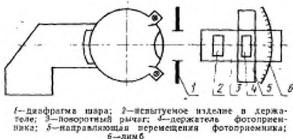
1—диафрагма шара; 2—испытуемое изделие в держателе; 3—поворотный рычаг; 4—держатель фотоприемника; 5—направляющая перемещения фотоприемника; 6—лимб
