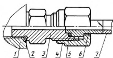
1 — гнездо; 2 — прокладка; 3 — штуцер; 4 — накидная гайка;
