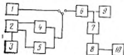
1—источник напряжения переменного тока; 2, 8—потенциометр постоянного тока; 3, 10—образцовые меры в.д.с. (нормальные элементы); 4—стабилизатор или образцовый преобразователь напряжения; 5—поверяемый прибор; 6—переключатель направления постоянного тока; 7—делитель напряжения постоянного тока; 9—источник напряжения постоянного тока
