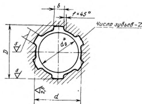
\* Диаметр отверстия до протягивания (для справок).
