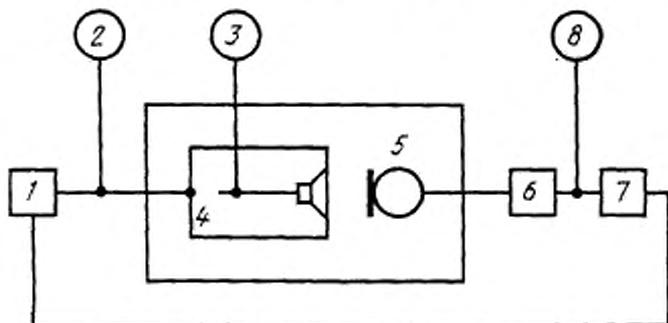
1—УАЗЧ; 2, 3, 8—электронный вольтметр; 4—испытуемое изделие; 5—измерительный микрофон; 6—усилитель УМ; 7—следящий анализатор спектра
