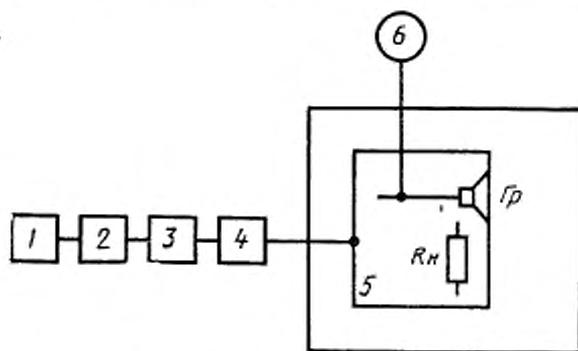
1—генератор ГНИ; 2—модулятор стереофонического сигнала МОД; 3—генератор ГСВ2; 4—эквивалент антенны (в случае необходимости); 5—испытываемый стереофонический приемник; 6—электронный вольтметр; Гр—акустическая система одного из каналов; В—эквивалент акустической системы другого канала
