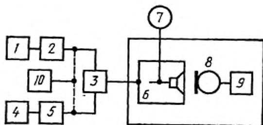
1—генератор полного телевизионного сигнала; 2—ГСВ1; 3—разветвитель; 4—ГНИ; 5—ГСВ2; 6—испытываемый телевизионный приемник; 7—электронный вольтметр; 8—измерительный микрофон шумомера; 9—шумомер; 10—частотомер
