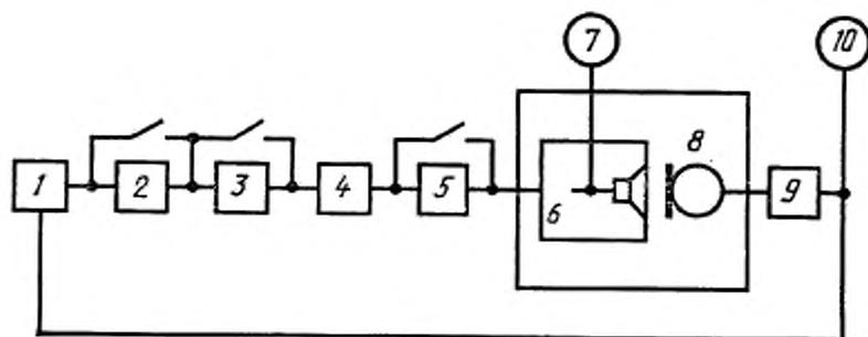
1—УА3СХ; 2—цель предискажений; 3—стереофонический модулятор; 4—генератор ГСВ2; 5—эквивалент антенны; 6—испытываемый радиовещательный приемник; 7, 10—электронный вольтметр; 8—измерительный микрофон; 9—усилитель УМ
