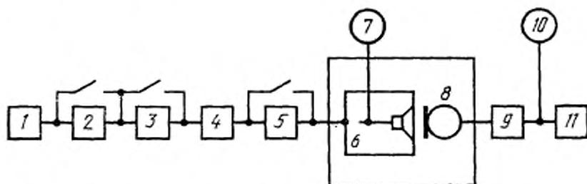
1—генератор ГНИ; 2—цепь предуслаживания; 3—стереофонический модулятор; 4—генератор ГСВ2; 5—эквивалент антенны; 6—испытуемый радиовещательный приемник; 7, 10—электронный вольтметр; 8—измерительный микрофон; 9—усилитель УМ; 11—ИНИ, анализатор спектра или селективный вольтметр
