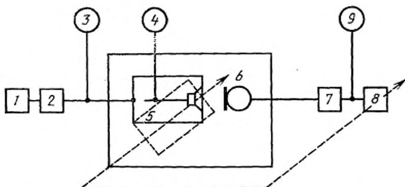
1—генератор ГШН; 2—полосовой третьоктавный или октавный фильтр; 3, 4, 9—электронный вольтметр; 5—испытуемое изделие; 6—измерительный микрофон; 7—усилитель УМ; 8—установка для автоматической записи диаграммы направленности
