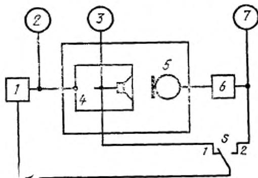
1—УАЗЧХ; 2, 3, 7—электронный вольтметр; 4—испытуемое изделие; 5—измерительный микрофон; 6—усилитель УМ; S—переключатель
