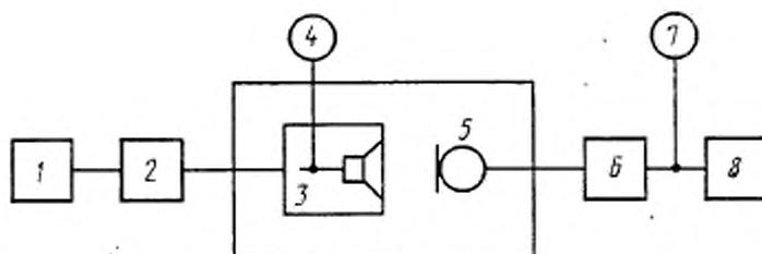
1 — ГНИ; 2 — ГСВ1; 3 — испытуемый трехпрограммный приемник (канал РЧ); 4, 7 — электронный вольтметр; 5 — измерительный микрофон; 6 — усилитель УМ; 8 — ГНИ, анализатор спектра или селективный вольтметр
