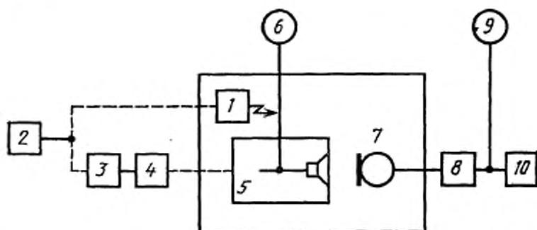
1—генератор поля; 2—генератор ГНИ; 3—генератор ГСВ1; 4—эквивалент антенны; 5—измеряемый радиовещательный приемник; 6, 9—электронный вольтметр; 7—измерительный микрофон; 8—усилитель УМ; 10—ИНИ, анализатор спектра или селективный вольтметр
