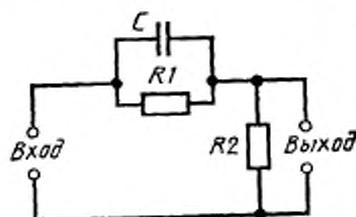
$R1$ —резистор сопротивлением  $100 \text{ кОм} \pm 1\%$ ;  $R2$ —резистор сопротивлением  $3 \text{ кОм} \pm 1\%$ ;  $C$ —конденсатор емкостью  $500 \text{ пФ}$  ( $\tau = 50 \text{ мкс}$ ) или  $750 \text{ пФ}$  ( $\tau = 75 \text{ мкс}$ ). Точное значение подбирают при настройке цепи
