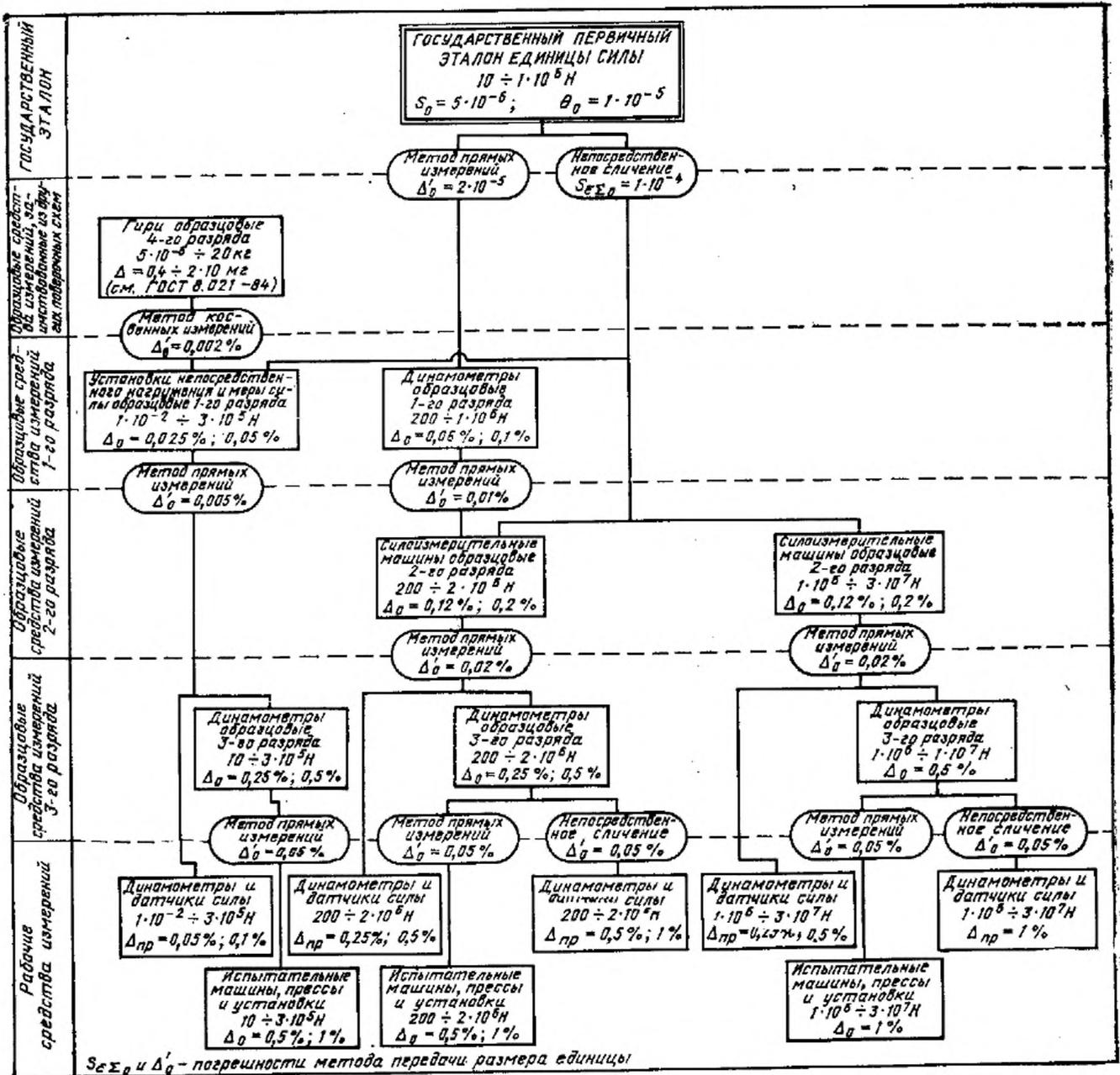
2.3.2. Пределы допускаемых относительных погрешностей  $\Delta_0$  образцовых средств измерений 2-го разряда составляют 0,12 и 0,2%.
