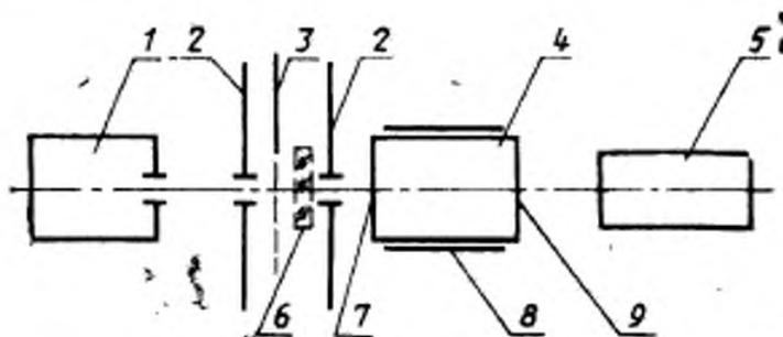
1—источник света; 2—светозащитная диафрагма; 3—заслонка; 4—ЭОП;
