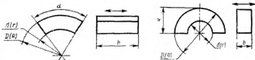
$\alpha$ —угол сектора магнита;  $R$ —наружный радиус;  $r$ —внутренний радиус
